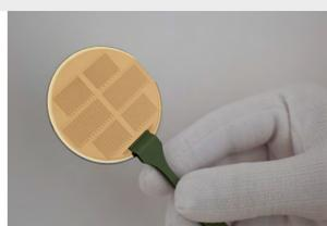
GaN Wafer mit Laserdioden
